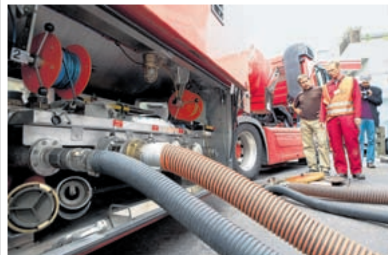
Kreislauf. Die Dämpfe, die beim Befüllen der Tanks unter den Tankstellen entweichen, werden wieder aufgesogen. Fotos Henry Muchenberger
