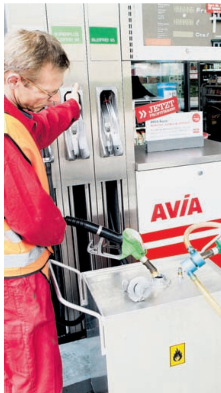
Flächendeckende Kontrolle. Ein Experte des Lufthygieneamts überprüft, ob die Benzingasrückführung ordnungsgemäss funktioniert.
